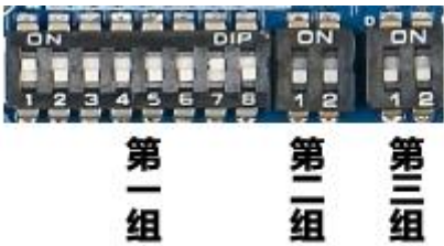
图 2-4 AD-S341-I1P2-MS 模块拨码开关
